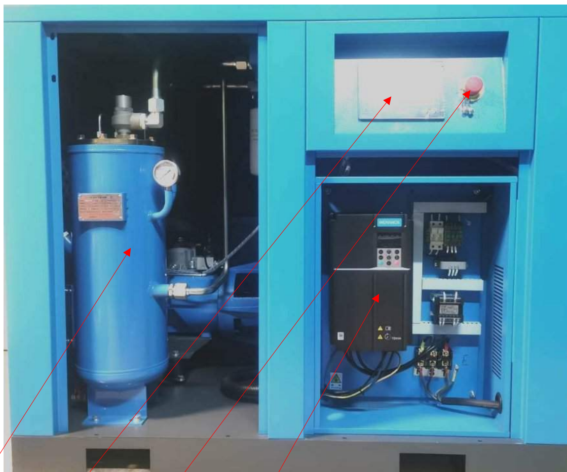
4 – eļļas – gaisa separators, 5 – vadības kontrolieris, 6 – STOP poga, 7 – frekvenču pārveidotājs Zīm. 5
